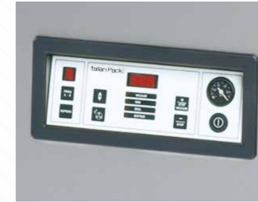
Scheda elettronica Italian Pack di nuova generazione con 10 programmi.
